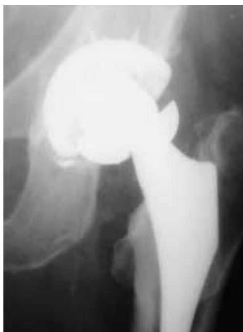
Figura 1. Radiografía anteroposterior con rotura de la cabeza de cerámica (prótesis ABG-I) a los 11 años de haber sido implantada.
