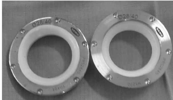
Figura 3. Fotografía del anillo de bloqueo retirado (derecha) mostrando deformación del polo inferior de la porción de polietileno, comparado con un anillo no utilizado (izquierda).
