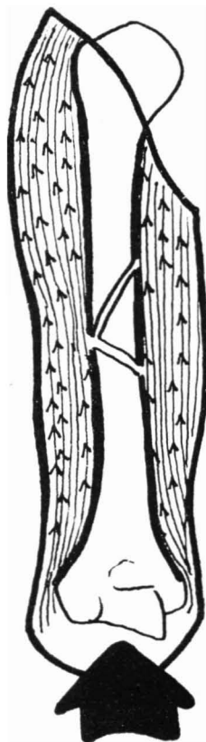
FIG. 5. — El yeso de contacto total realiza una acción de «zuncho» a lo largo de todo el segmento, enfundándolo como por cientos de capas longitudinales y concéntricas.
