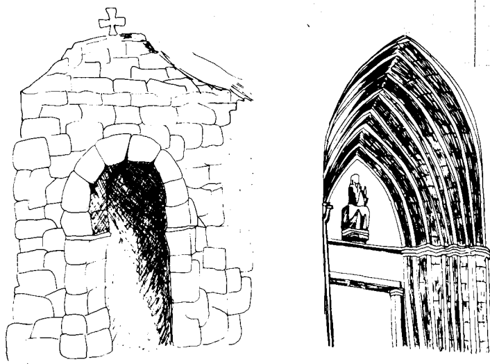
FIG. 7.— Evolución del concepto arquitectónico de arco: a) Arco románico. b) Arco gótico.
